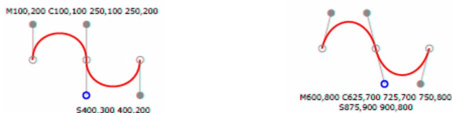
Abbildung 13: Pfadelemente können mit Kontrollpunkten versehen werden. Im Beispiel kann dadurch die Bézierkurve verzerrt werden (rechts). [Spez03]
